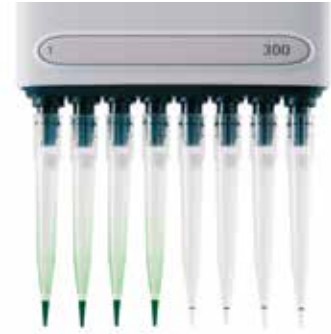
普通吸头 低吸附吸头 移液后吸头内液体残留量对比
