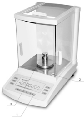
1. 面板(分单量程电子天平和双量程电子天平 2. 水平仪 3. 称盘
