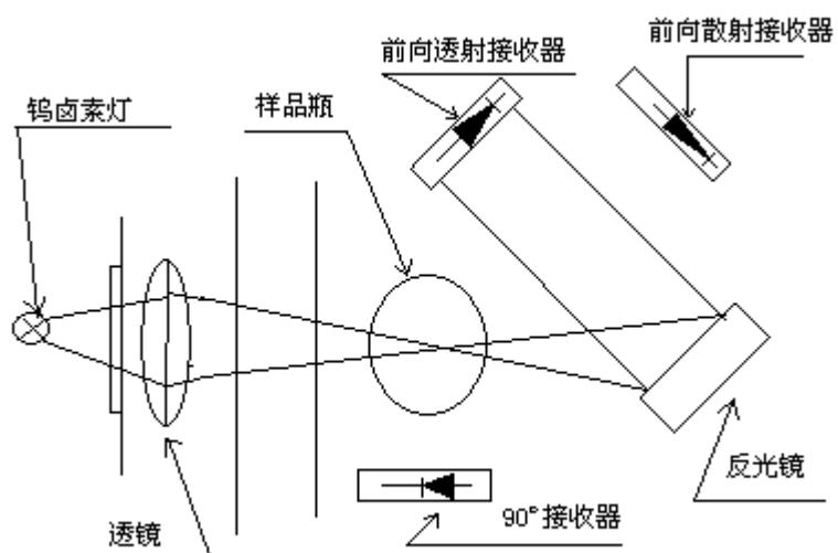
光通过透镜聚焦后照射到样品瓶上，一部分信号由  $90^\circ$  接收器接受，另外分别由前向透射接收器和前向散射接收器接收。
