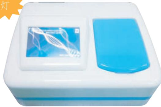
X-1系列紫外可见分光光度计独立三点式悬挂系统固定脉冲氙灯光源，克服了材料应力的影响，强化了光源组件的抗震效果，提高了整机的稳定性和可靠性。X-1系列是一台没有二次污染的清洁、低耗、快速、高效的环保型科学仪器。该仪器的各项性能指标达到目前国际同类产品的先进水平，完美的性能体现能满足95%以上用户的需求。
