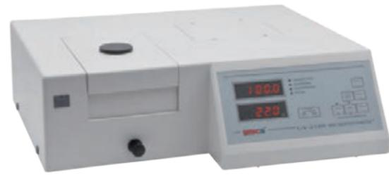
新型 2100 系列分光光度计有着良好的精准度，采用 5nm 精度设计，高品质的硅光电二极管检测器和 1200 条 / 毫米衍射光栅保证了其高性能。自动设置波长，清晰的数字显示和内置自动检测器，便于操作。2100 系列主要功能有吸光度、透过率、因子和浓度等模式，以及一键自动调零功能。
