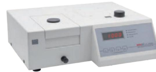
新型 2000 系列分光光度计有着良好的精准度，采用 4nm 精度设计，高品质的硅光电二极管检测器和 1200 条 / 毫米衍射光栅保证了其高性能。2000 系列主要功能有吸光度、透过率、因子和浓度等模式，以及一键自动调零功能。
