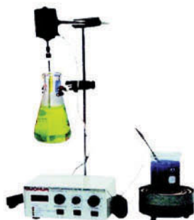
JJ-3 数显控温定时电动搅拌器
