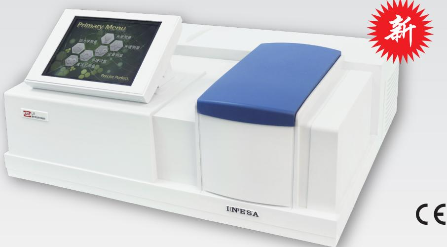
L9双光束紫外可见分光光度计，采用了全新的光学平台，5档带宽可调，ARM芯片控制和处理数据，8英寸彩色触摸屏显示菜单、光谱图和分析测试数据，人机交互操作简便。仪器具有光度测量、自动扫描光谱测量、定量分析、动力学分析、多波长测量等功能。
