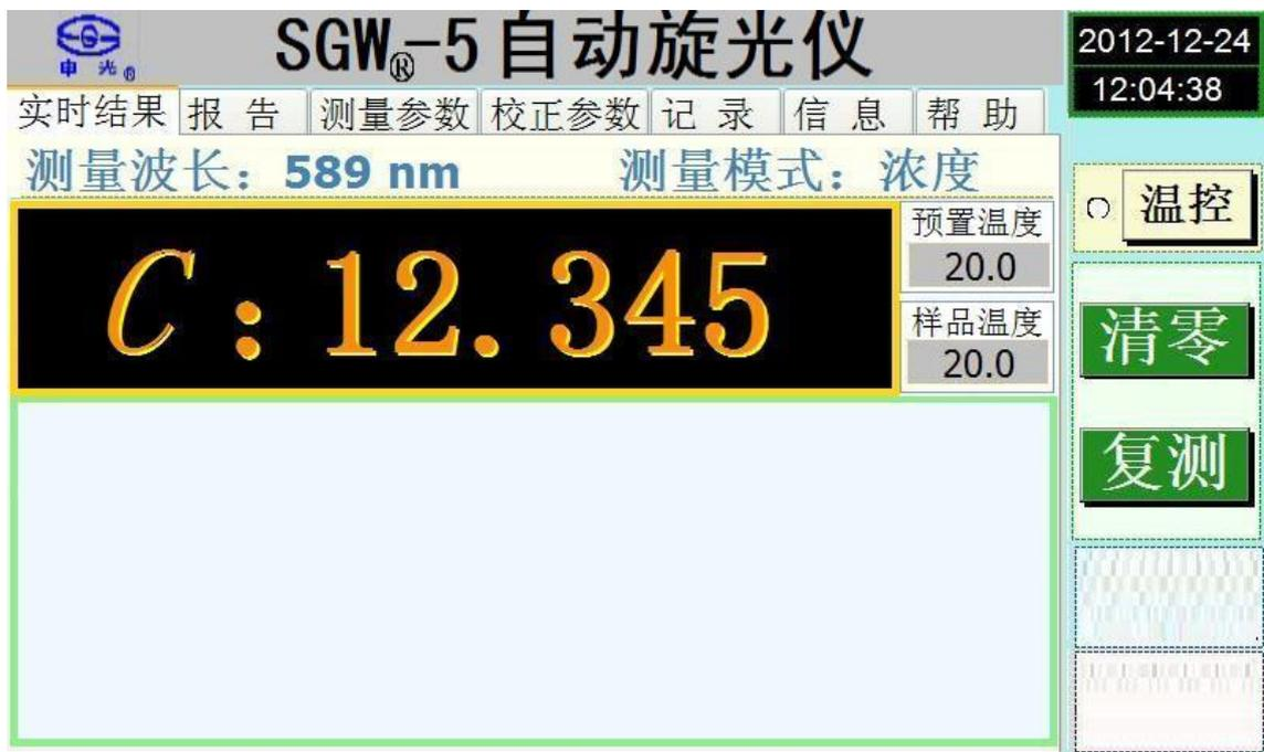
测量模式为测浓度时，需要在设置时输入试管长度（mm）、溶液比旋度。
