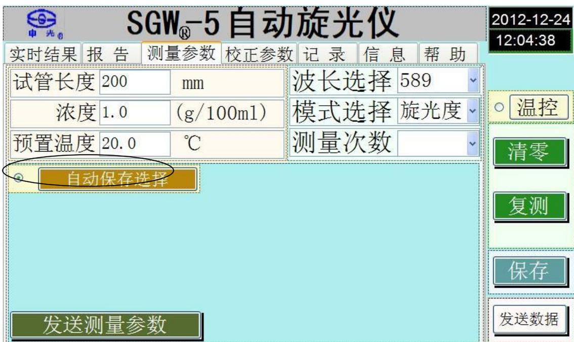
注：选择测量参数后，必须按“发送测量参数”键确认。
