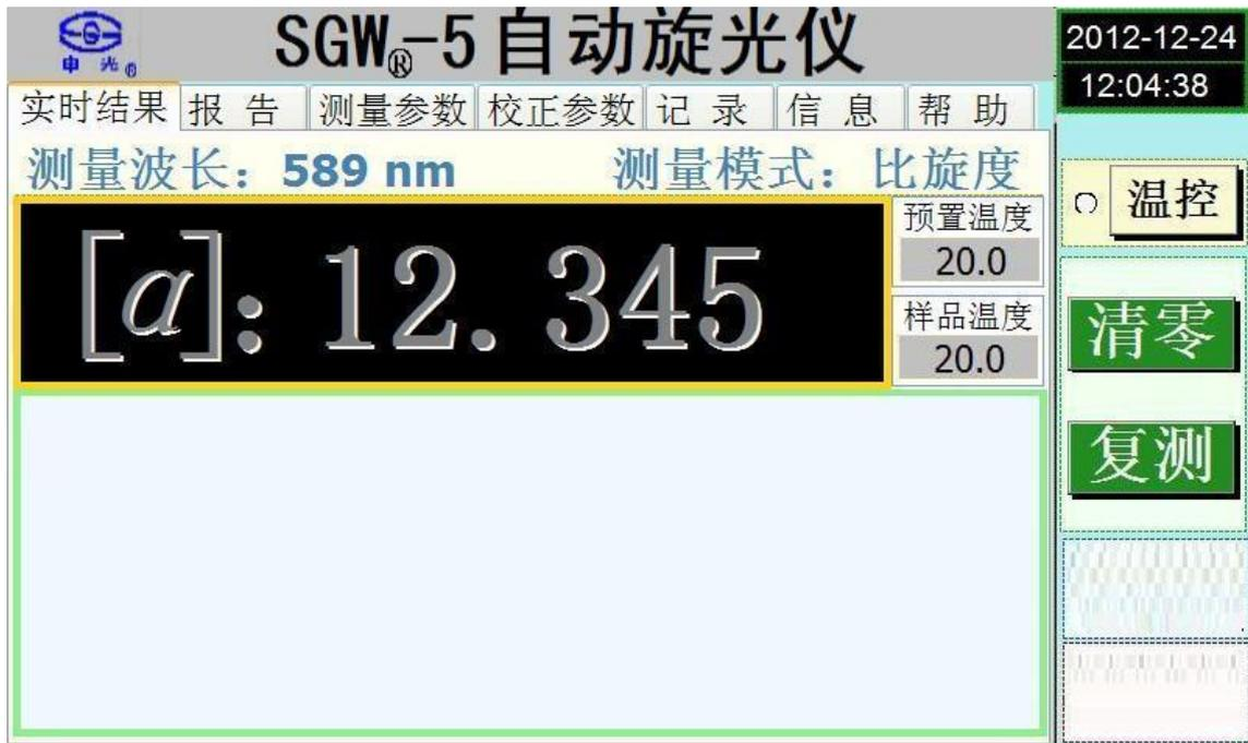
测量模式为测比旋度时，需要在设置时输入试管长度（mm）、溶液浓度。
