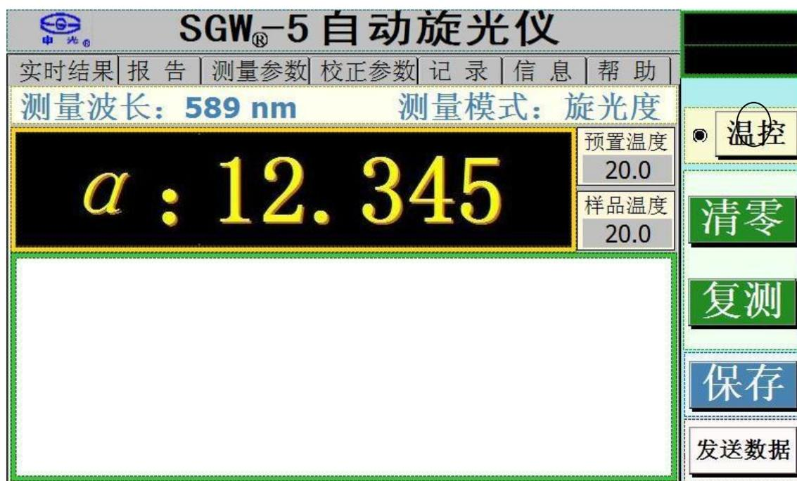
若需要规定温度的测量值，则必须当温度稳定后按动复测键，以确保测试结果的正确。
