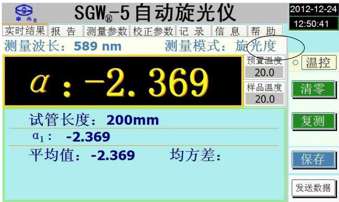
当测量完成后，按上图中的“旋光度”键，则可显示比旋度数值。同理，当测量模式是“比旋度”时，按“比旋度”键，则可显示旋光度数值。当测量模式是“浓度”时，按“浓度”键可显示旋光度数值。当用户再按上述键时，则有返回显示原测量模式数据。
